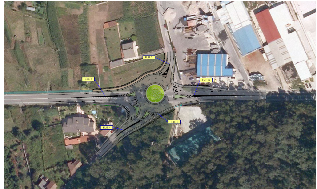
Figura 6. Implantación de la glorieta proyectada en el P.K. 14+430 de la PO-551
